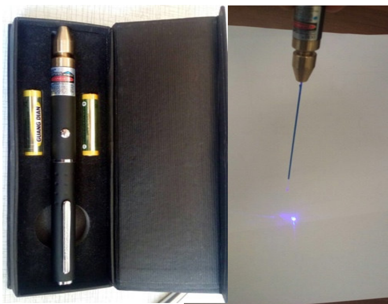
Рисунок 7 - Модель ультрафиолетового облучателя для антисептической обработки пародонтальных карманов
